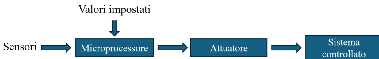
Figura 12. Schema di controllo dei sensori di mitigazione ambientale (Fonte: Abeni et al., 2024).
