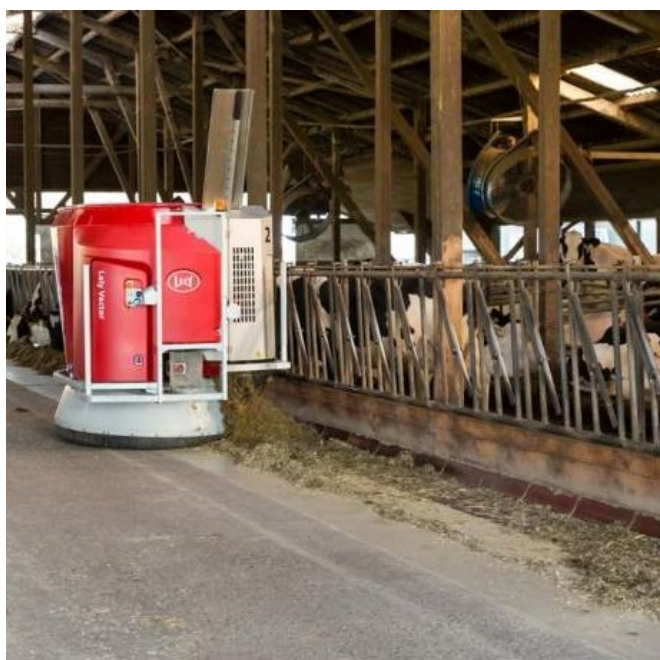
Figura 14. Carro di distribuzione semovente durante la distribuzione di alimento (Fonte: https://macchineagricolenews.edagricole.it/innovazioni-tecniche/carri-miscelatori-allunifed-ci-pensa-il-robot/ ).
