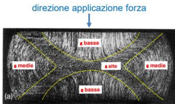
Figura [26] – Disposizione fibre nel provino
