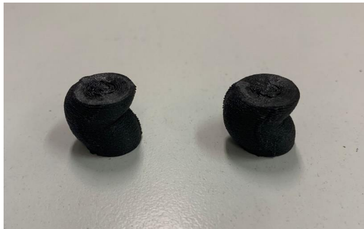
Figura [27] – Provini CarbonFil™ deformati post-compressione
