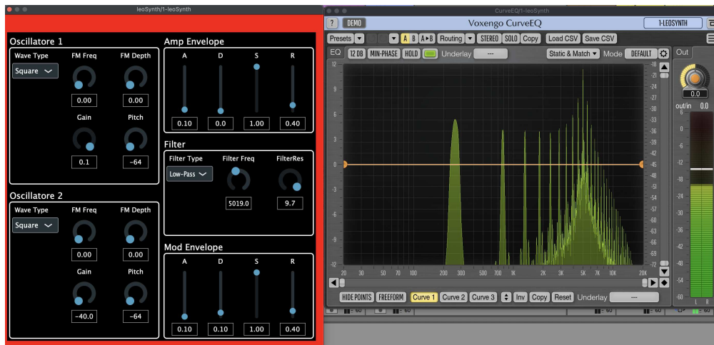
Figura 4.4: Square Wave + Filter Resonance @ 5kHz: Il segnale generato dall'onda quadra viene tagliato dalla frequenza 5kHz in poi, con un'enfasi di 9.7. (DO4, 262Hz)
