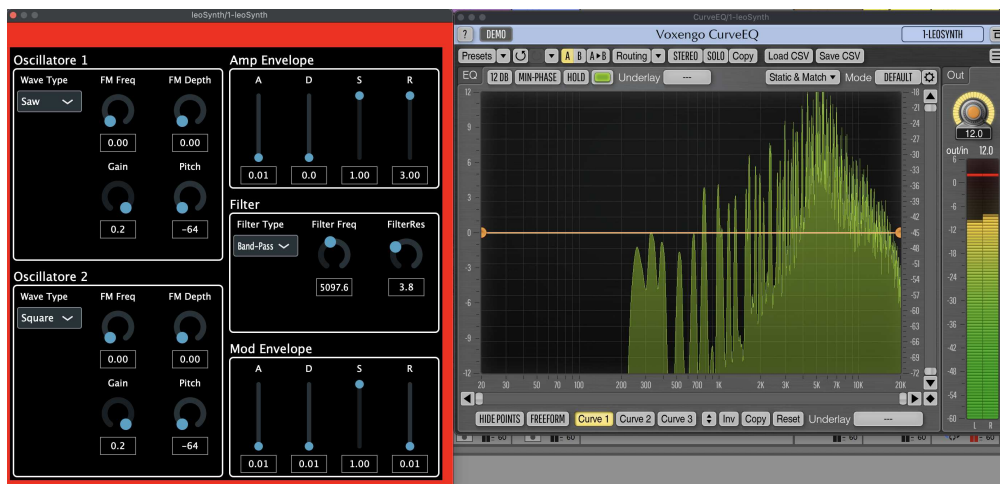
Figura 4.5: Chord: Square + Saw + Filter Resonance @5kHz. Accordo di Do Maggiore con enfasi intorno alla frequenza 5kHz. (DO4, 262Hz) + (MI4, 330Hz) + (SOL4, 392Hz)
