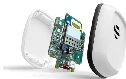
Figura 2.2 Esploso del Tag IMU Sewio.
