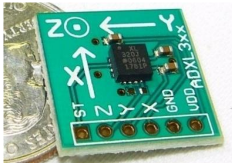
Figura 1.3 Dimensioni accelerometro MEMS a tre assi.
