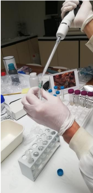
Figura 28a. Prelievo del campione e l'inserimento nelle provette
