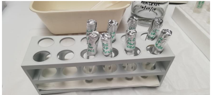
Figura 28b. Copertura delle provette con tappo in alluminio
