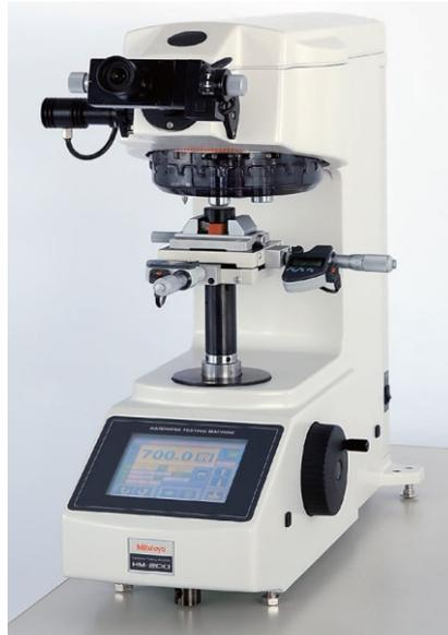
**Figura 2** – Durometro per la prova Vickers.
