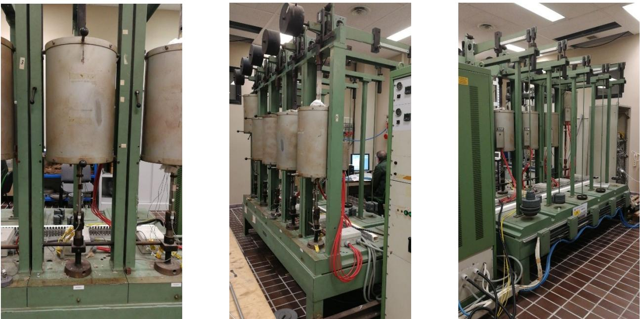
**Figura 6** – Immagini rappresentanti le macchine per la prova creep.
