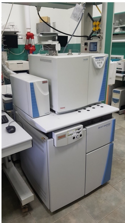
Figura 16. Spettrometro di massa IRMS Thermo Delta Plus XP & Delta V Advantage utilizzato dall'Università di Palermo.
