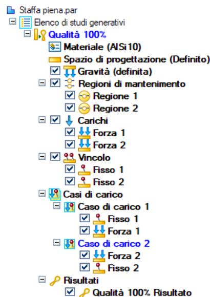
Figura 4.8: Workflow ottimizzazione Solid Edge 2020
