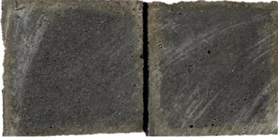
**Figura 5.4.8** – *Provino A a 3 mesi prova colorimetrica*
