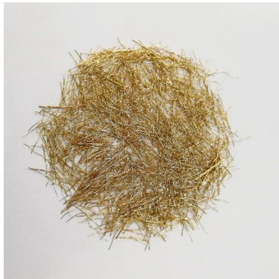
**Figura 2.2.1** – *Fibre in acciaio ottonate*
