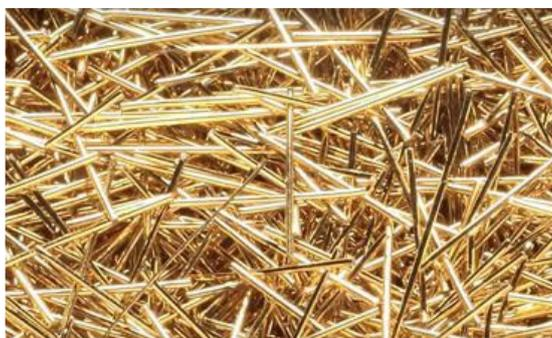
**Figura 4.2.1.5** – *Fibra in acciaio rivestita in ottone*
