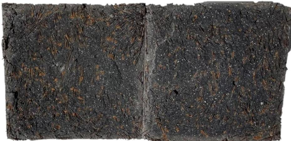
**Figura 5.4.4** – *Provino C a 1 mese prova colorimetrica*
