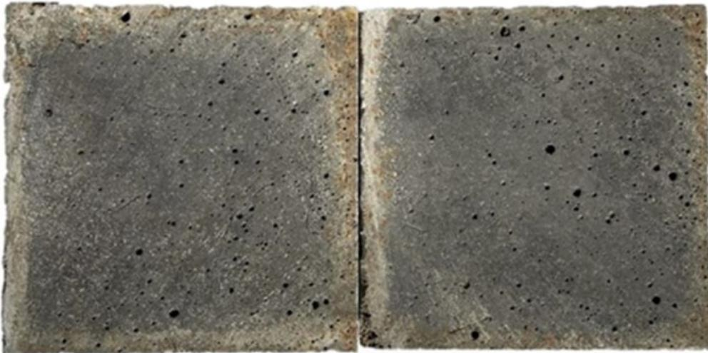
**Figura 5.4.9** – *Provino B a 3 mesi prova colorimetrica*
