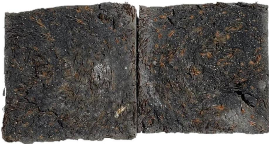
**Figura 5.4.3** – *Provino B a 1 mese prova colorimetrica*
