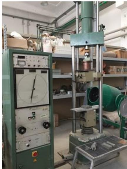
**Figura 4.6.1.1-** *Pressa idraulica*
