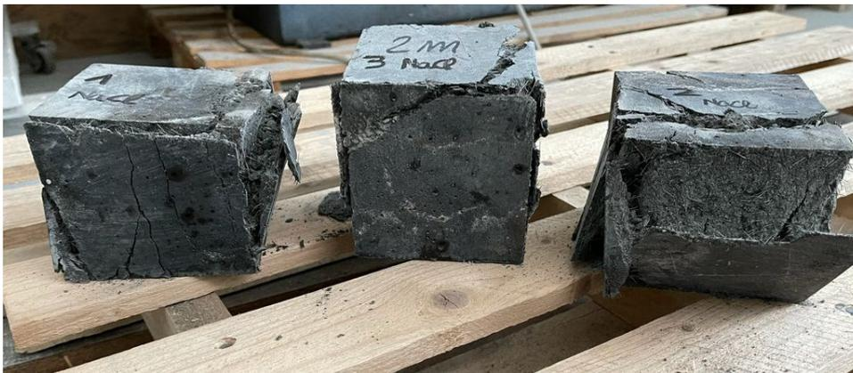
**Figura 4.6.2.5** – Cubetti al termine della prova immersi in NaCl
