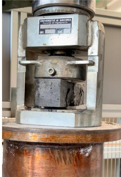
**Figura 4.6.2.1** – Setup di prova a compressione provini  $4 \times 4 \times 16 \text{ cm}^3$
