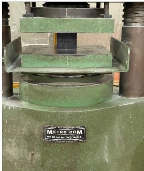
**Figura 4.6.2.3** – Setup di prova a compressione provini 10x10x10 cm<sup>3</sup>
