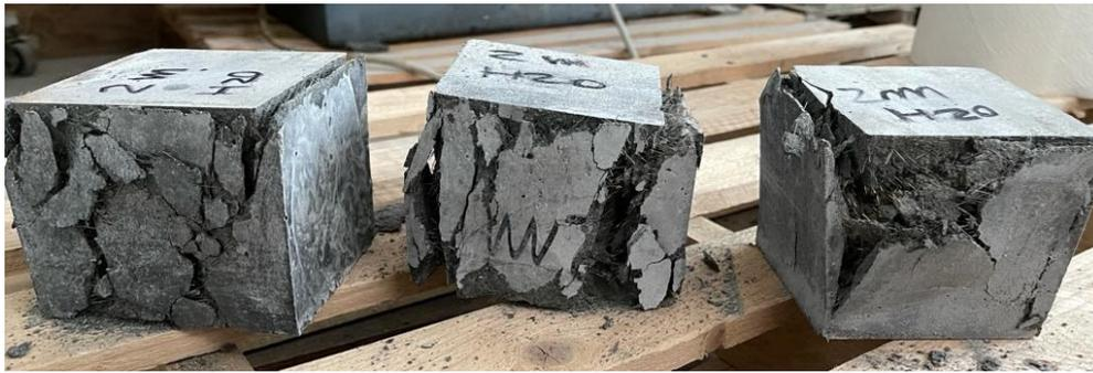
**Figura 4.6.2.4** – Cubetti al termine della prova immersi in H<sub>2</sub>O
