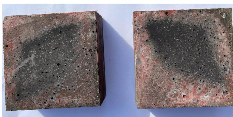
**Figura 4.6.3.2** – *Reazione con nitrato d'argento provino A – 2 mesi*
