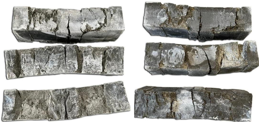
**Figura 4.6.2.2** – Rottura a compressione provini in  $H_2O$  e  $NaCl$
