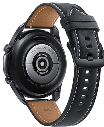
Figura 9. Sensore PPG situato sul retro dello smartwatch Samsung Galaxy Watch3.
