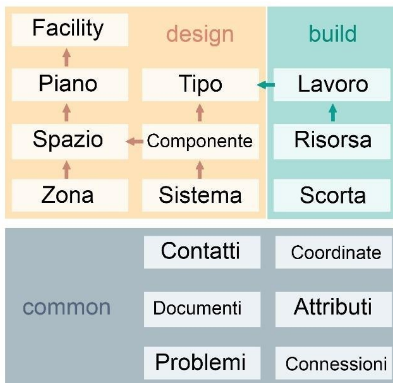
Figura 155 - Struttura dati COBie
