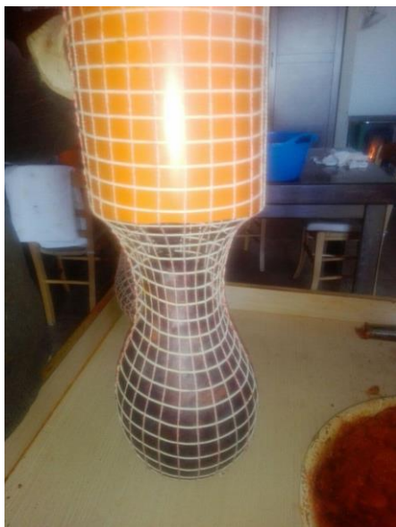
Figura 16 - Legatura effettuata mediante cilindro cavo
