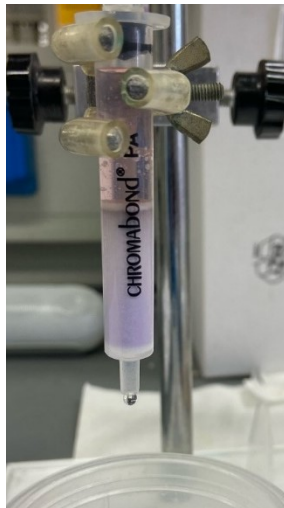
Figura 15: Cartucce SPE, Chromabond, Poliammide durante la fase di condizionamento necessaria per l'estrazione SPE
