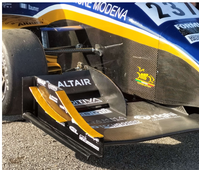
Figura 66: soluzione tipo "muro", More Modena Racing
