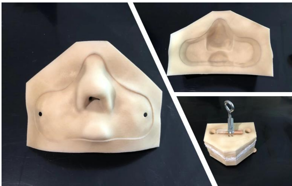
Figura 8. Stampi ottenuti con tecnologia 3D
