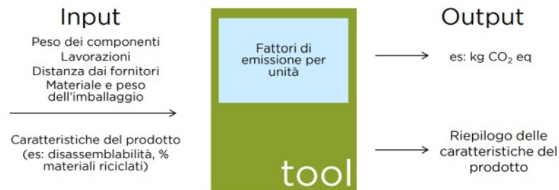
Figura 10 – Input e Output tool SimaPro
