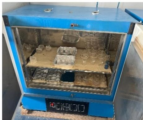
**Figura 38 – Stufa alla temperatura di 65°C**
