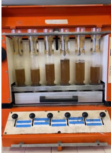
**Figura 37 – Fibertech in funzione**
