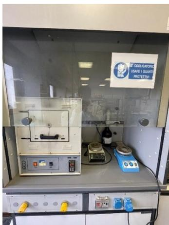
*Figura 35 – Forno a muffola (a sinistra) all'interno della cappa*
