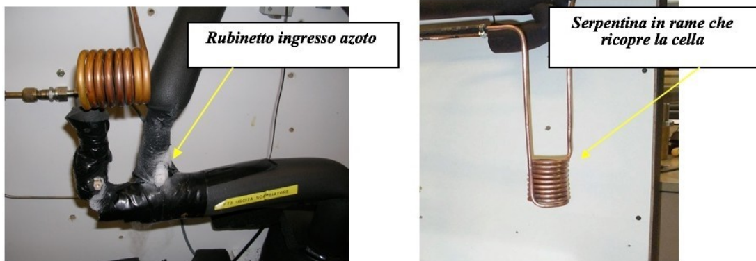
Fig. 2.3. Serbatoio ingresso azoto e serpentina in rame
