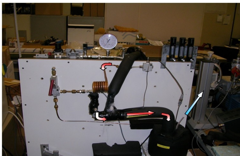
Fig.2.9 Modalità di funzionamento in riscaldamento
