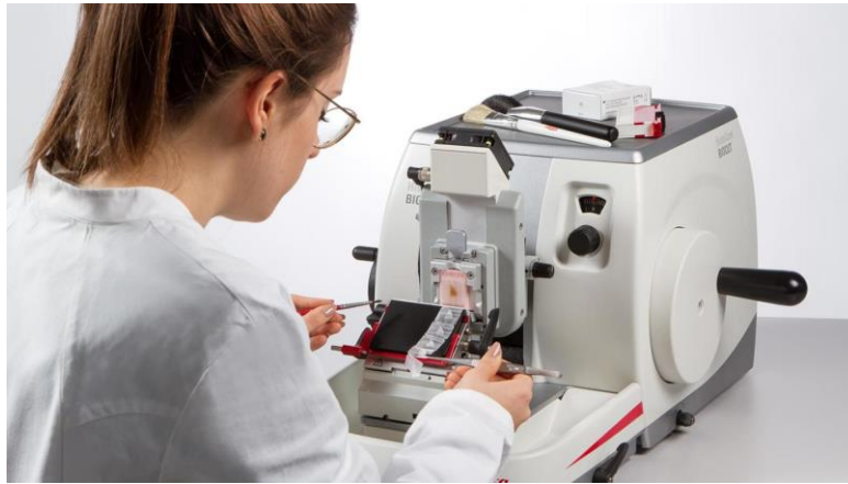
Fig. 2.3.2.3 – taglio e stesura del campione sul supporto della lama (HistoCore BIOCUT - Microtomo rotativo manuale (leicabiosystems.com))
