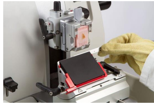
Fig. 2.3.2.2 – Posizionamento lama nel microtomo
