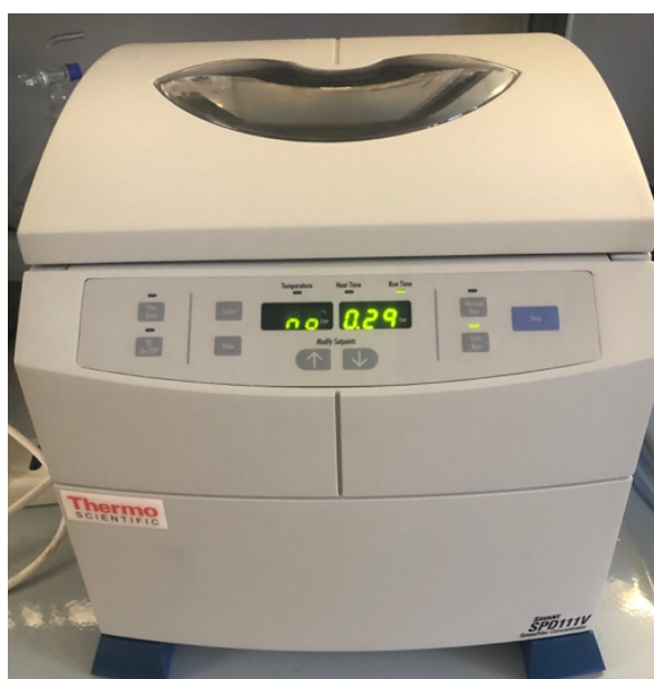
Figura 22. I campioni sono stati inseriti all'interno della centrifuga (SpeedVac Concentrator, Savant SPD111V), per l'eliminazione
