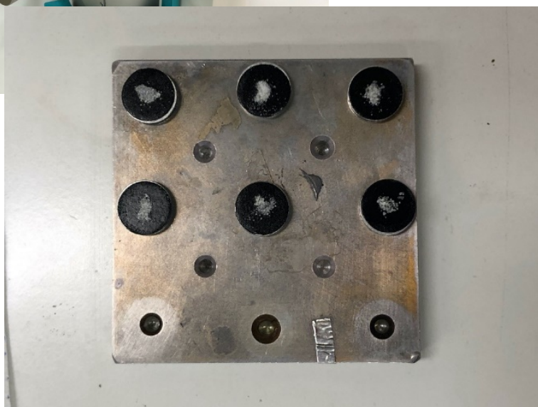
Figura 28a. Campioni disposti nei supporti e dorati per l'analisi EDS.
