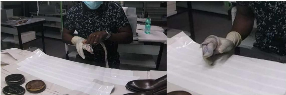
*Figura 24 – Posizionamento del panno sulle dita della mano desinata alla lucidatura, task 3.*
