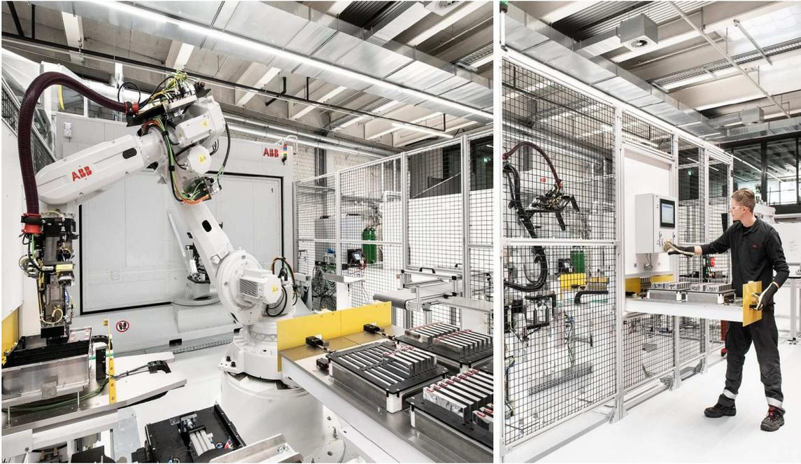
*Figura 4 – Robot antropomorfo, o articolato, ABB con 6 assi isolato all'interno di una gabbia guidato dall'operatore che si trova all'esterno.*
