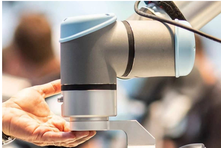
Figura 9: Esempio di guida manuale per cobot (UR5), Universal Robots
