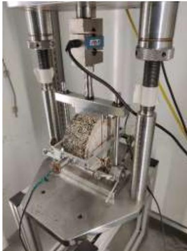
*Figura 4.33 - Provino posizionato nella macchina e trasduttori montati*
