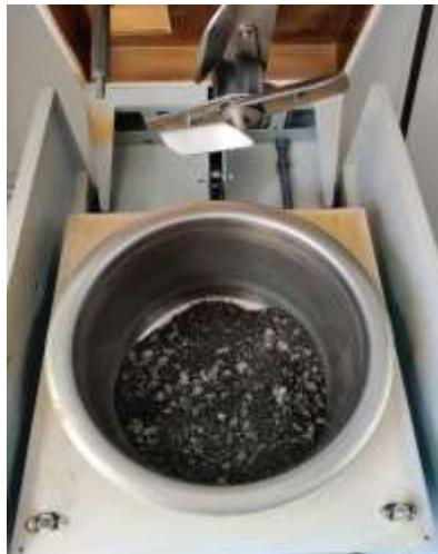
*Figura 4.11 - Aggregati nel miscelatore*
