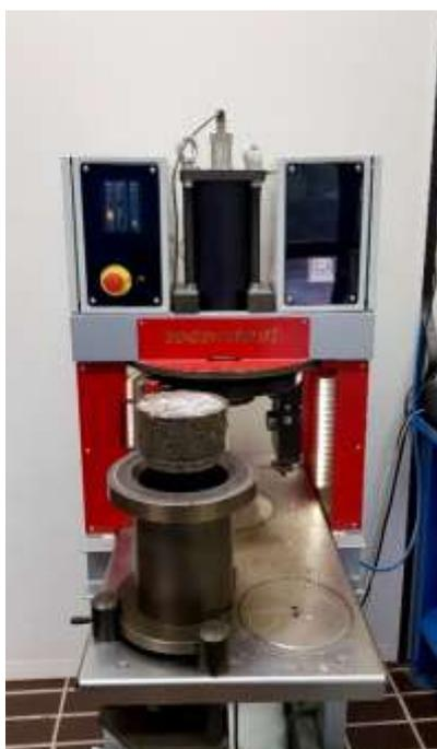
Figura 4.27 - Estrazione del provino
