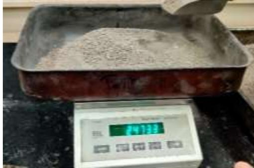
Figura 4.9 - Dosaggio degli aggregati secondo la ricetta stabilita
