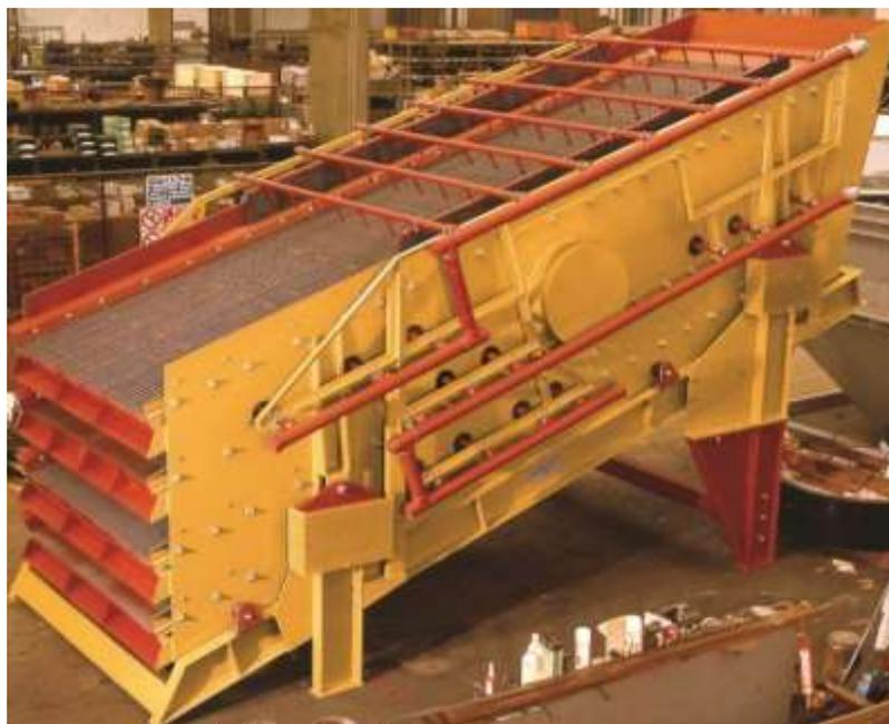
*Figura 3.1.: vagli vibranti inclinati*
