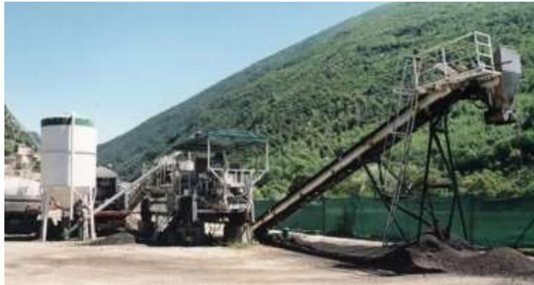
*Figura 2.4.: Impianto per la produzione del conglomerato a freddo*
