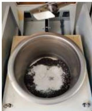
*Figura 4.12 - Aggregati e filler nel miscelatore*
