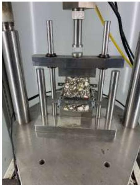
*Figura 4.51 - Castelletto e testa di carico contenenti il provino a cui sono attaccate barrette e trasduttori*
