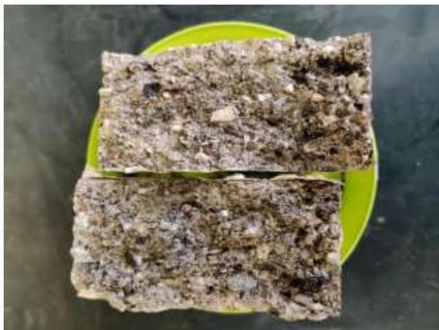
Figura 4.47 - Provino rotto a seguito della prova a trazione indiretta
