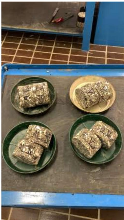
*Figura 4.8. - Provino carotato e tagliato per ottenere due provini per prova di fatica*
