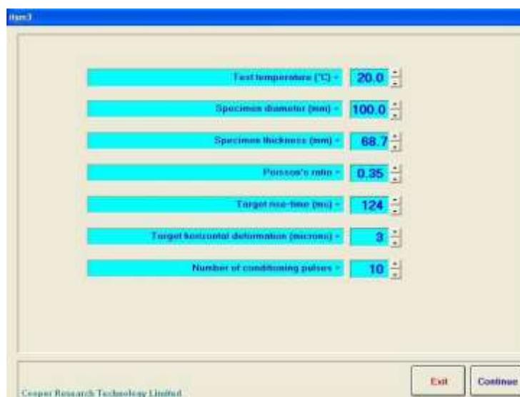
Figura 4.35 - Schermata iniziale del software ITSM con dati input
