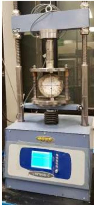
*Figura 4.43 - Posizionamento del provino tra i piatti della pressa*
