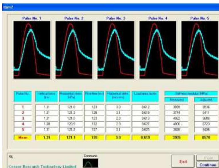
Figura 4.41 - Applicazione dei 5 impulsi di prova e visualizzazione dei risultati
