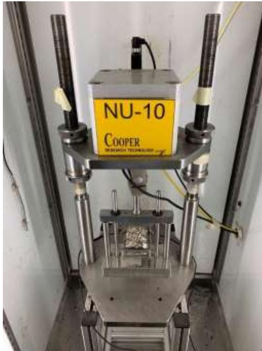
*Figura 4.50 - NAT in configurazione prova a fatica*
