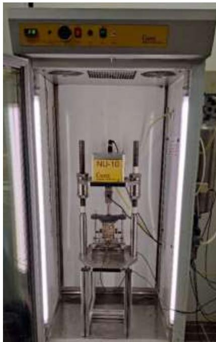
*Figura 4.34 - Cella di carico del NAT con al di sotto il castelletto contenente il provino*
