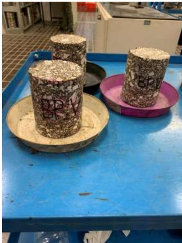
Figura 4.7. - Provino carotato e tagliato per la prova di modulo complesso a compressione
