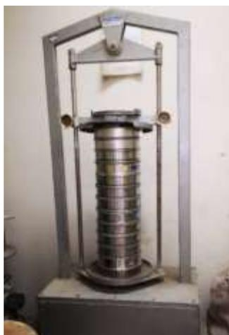
*Figura 4.1 - Pila di setacci posizionata nel vibro-vaglio*
