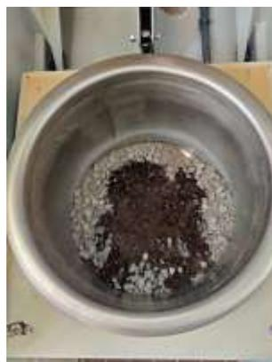
*Figura 4.15- Aggiunta dell'emulsione bituminosa nel miscelatore*
