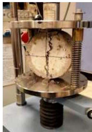
*Figura 4.44 - Provino rotto dopo la prova*
