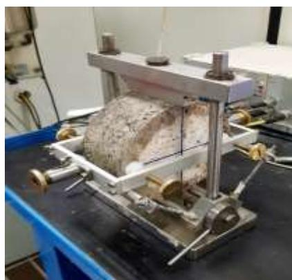
Figura 4.32 - Provino montato sul castelletto e testa di carico applicata
