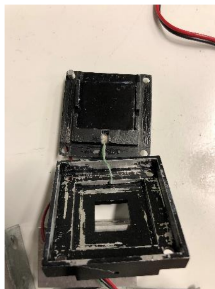
Figura 29: supporto aperto per inserimento campione
