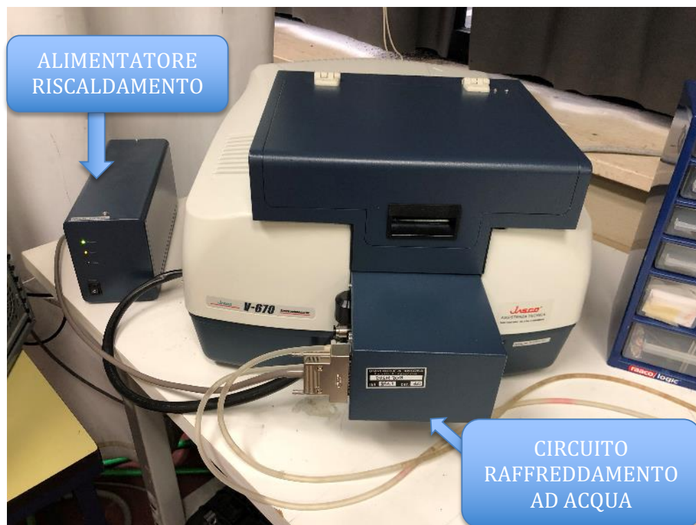
Figura 18: Spettrofotometro Jasco V 670, sfera integratrice da 60 mm termostata per prove di trasmittanza, circuito di raffreddamento ad acqua e alimentatore riscaldamento
