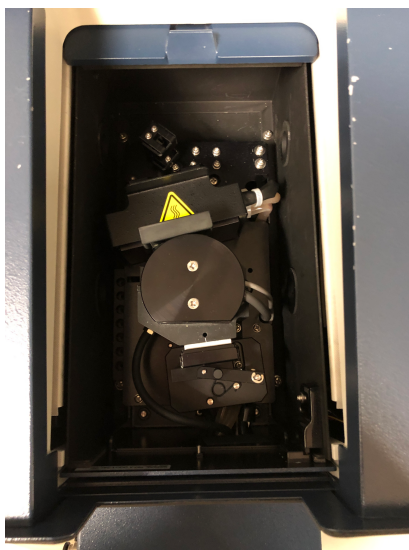
Figura 19: vista dall'alto della sfera integratrice ed alloggiamento campione
