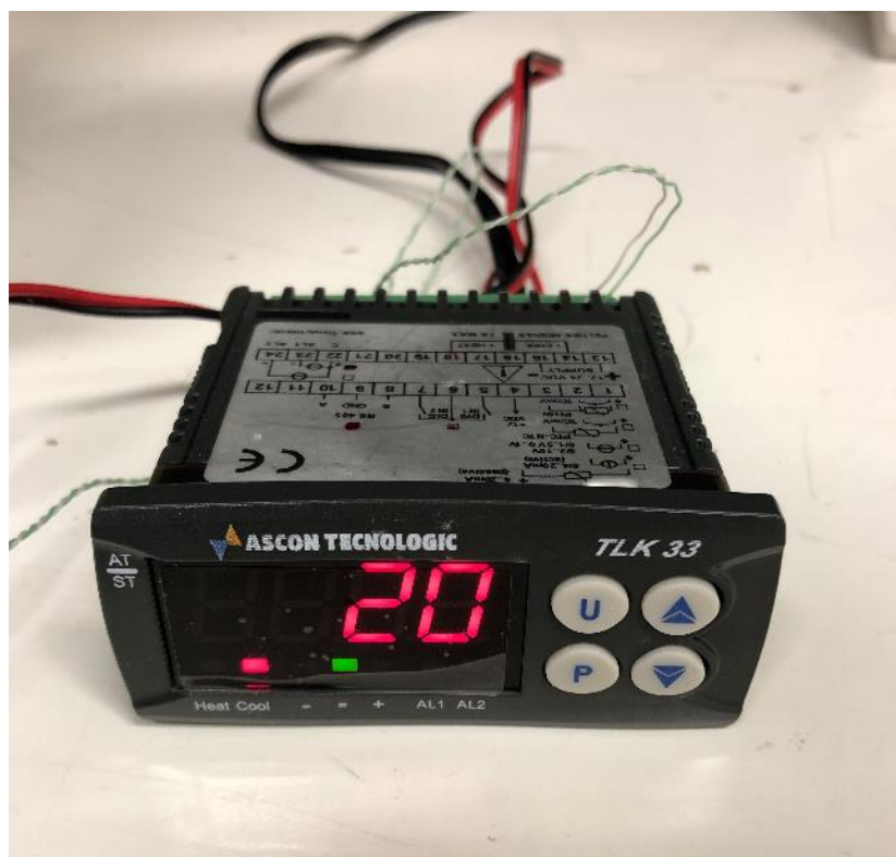
Figura 24: TLK-33 regolato a 20°C (temperatura iniziale per le prove) si notino i cavi di collegamento alla Peltier (rosso e nero), la termocoppia (bianco e verde) e l'alimentazione a corrente elettrica.
