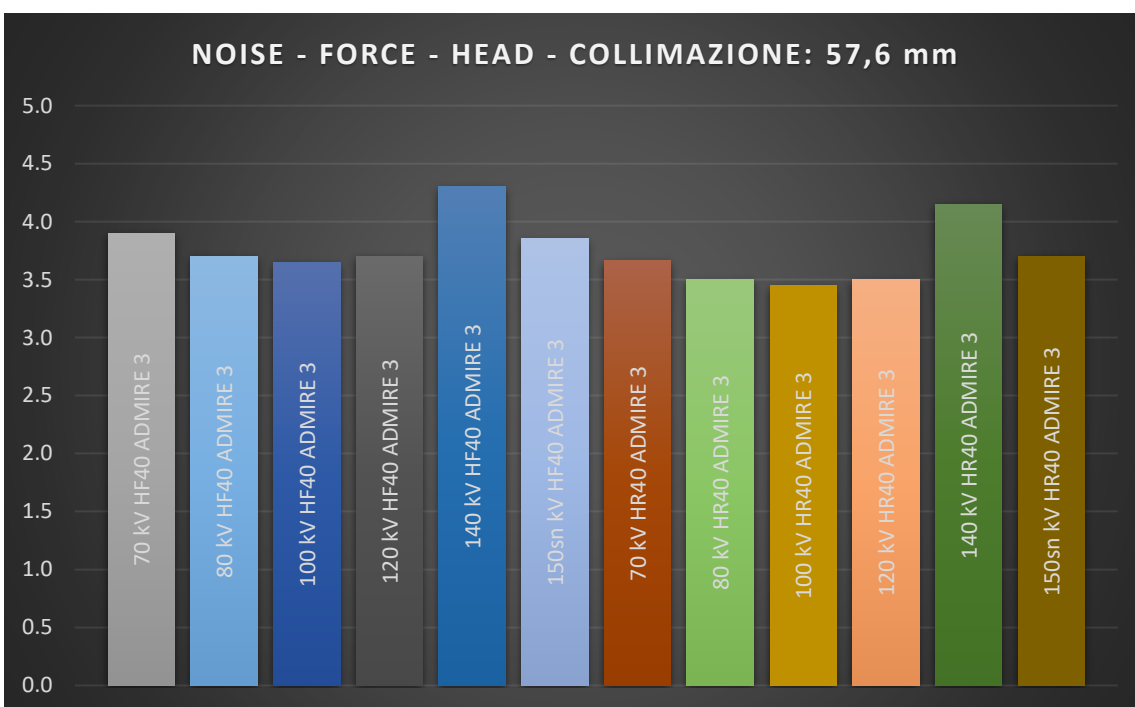
Fig. 6 – RUMORE AL VARIARE DELLE ENERGIE IN CT FORCE, COLLIMAZIONE 57.6 mm, LIVELLI DI RICOSTRUZIONE INTERMEDI, ACQUISIZIONE HEAD
