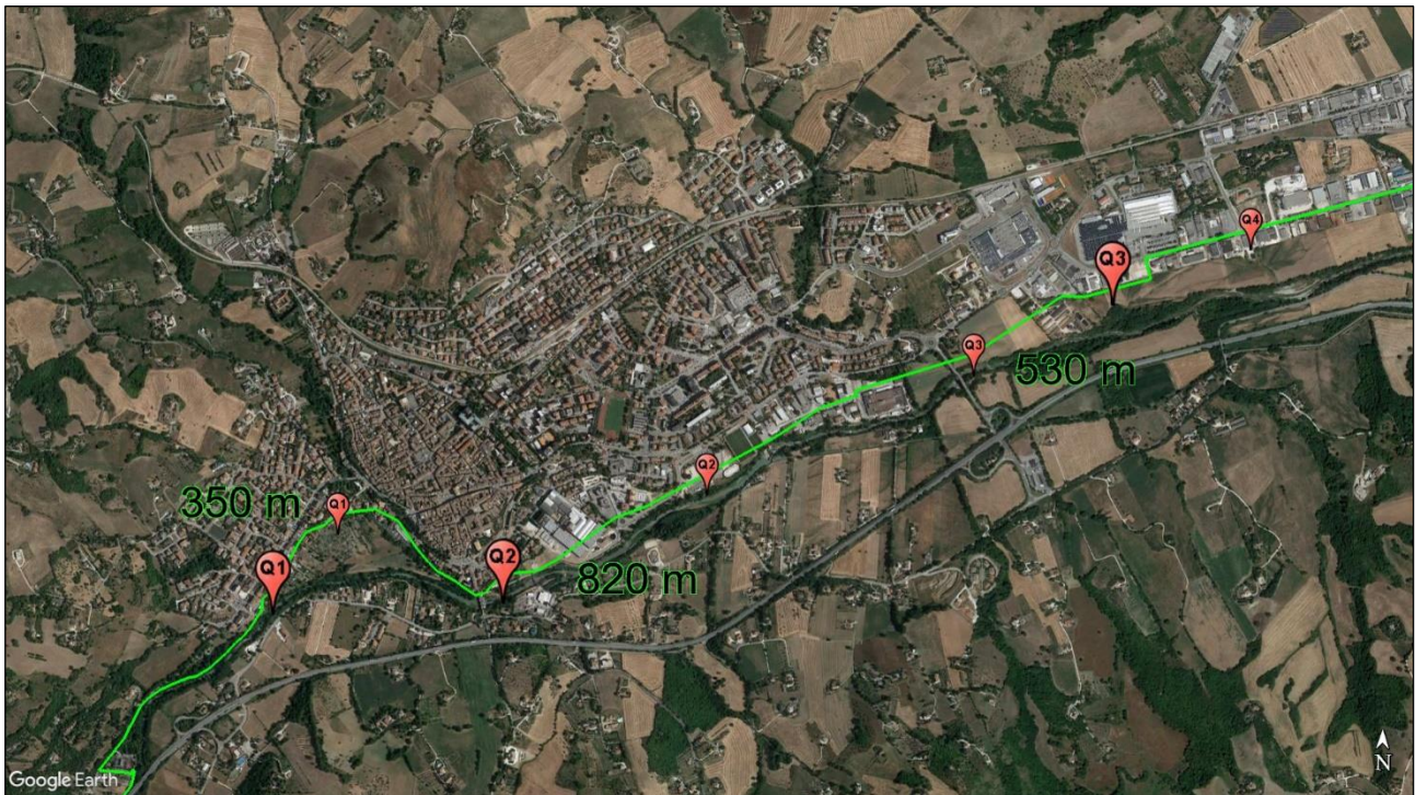
Figura 151 Posizioni e relative distanze dei tre misuratori di portata nelle due campagne di misura. Come si evidenzia dall'ortofoto i misuratori della prima campagna di misura sono indicati con segnaposto più grande rispetto a quelli piccoli della seconda.
