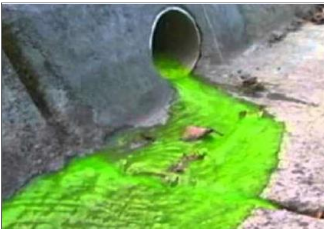
Figura 93 Test del colorante fluorescente dove si va a verificare l'effettivo collegamento tra la zona sospetta e un punto di fuoriuscita della rete. Fonte: Fast Ambiente Academy.
