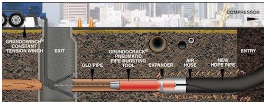
Figura 109 Schematizzazione per la metodologia del Pipe Bursting, in questo caso di tipo pneumatico. Fonte: https://www.statepipeservices.com/pipe-burstisng.html .
