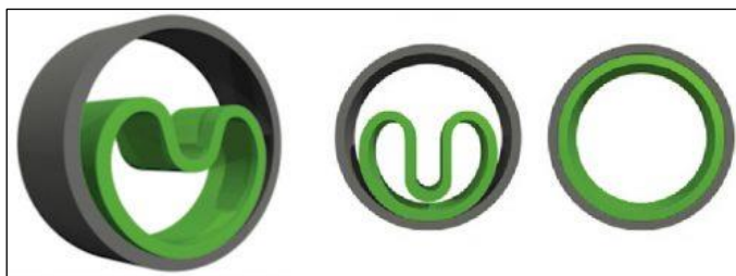
Figura 118 Deformazione a C con reversione e successiva adesione per il Lining ospitato all'interno della tubazione esistente Fonte: Patom.
