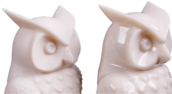
Figura 2.11: esempio di trattamento post processing (Levigatura chimica)
