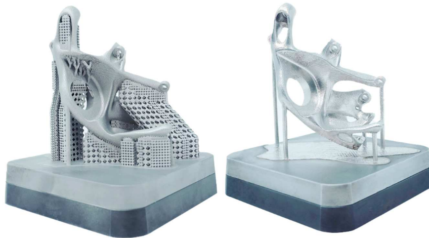
Figura 2.12: Rimozione supporti post stampa
