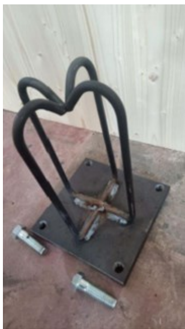
Figura 54 - Piastra e tirafondi in acciaio
