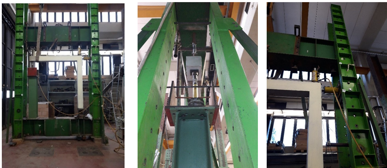
Figura 53 - Struttura in acciaio e posizionamento martinetti per la prova
