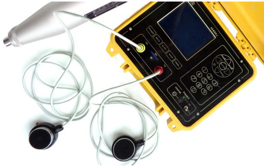
Figura 5 - Metodo SonReb, combinazione sclerometro e ultrasuoni.
