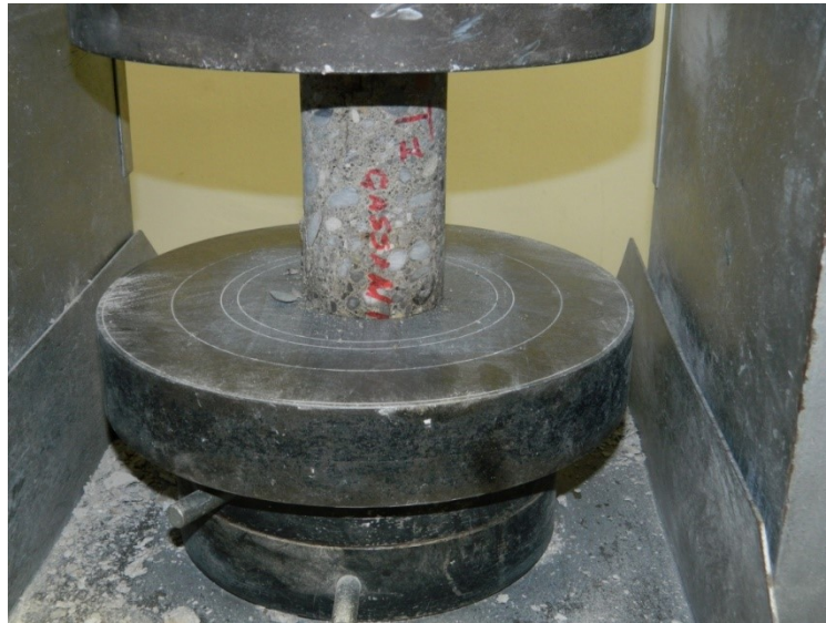
Figura 3 - Rottura compressione cilindrica.
