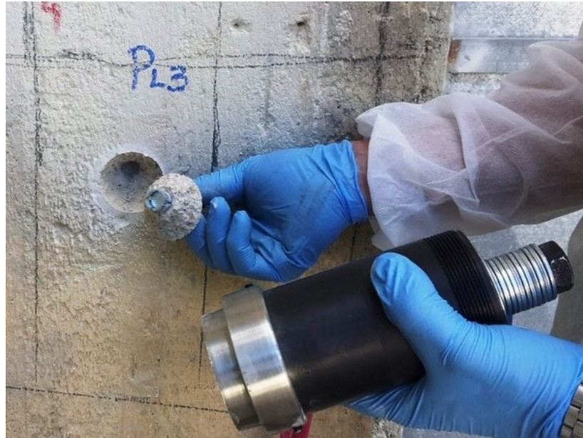
Figura 7 - Metodo Pull Out.
