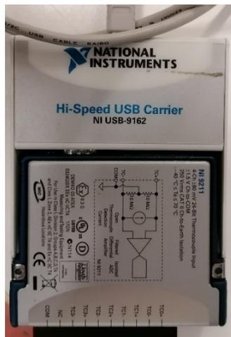
Figura 3.3 Scheda d'acquisizione NI USB-9211.
