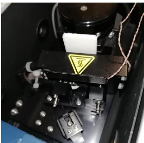
*Figura 3.5. Il campione (il tassello bianco che si vede al centro della figura è il portacampione) è pronto per la misura di trasmittanza.*
