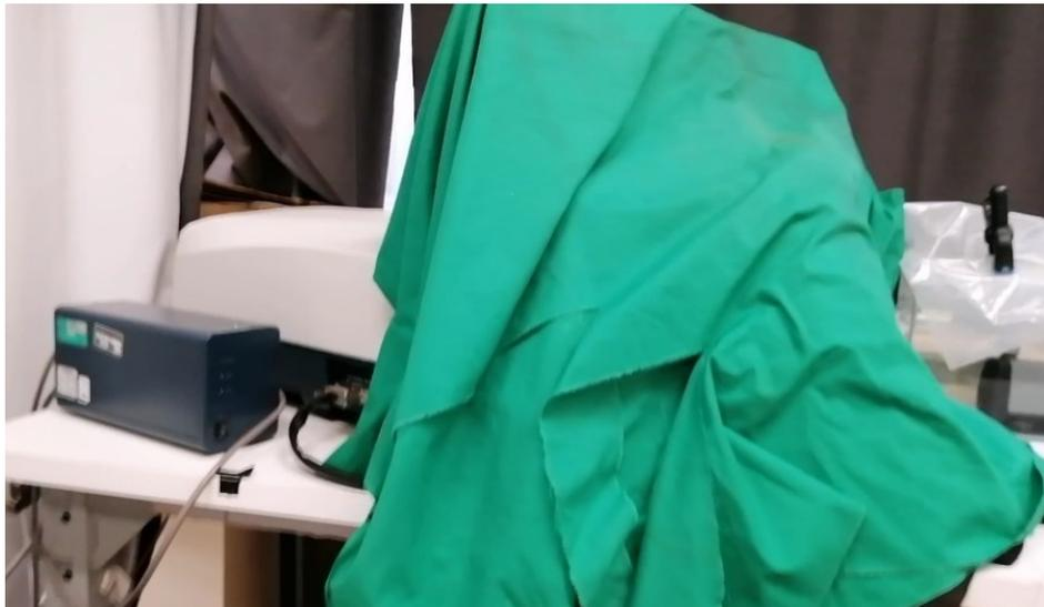
*Figura 3.8. Sfera integratrice ricoperta con teli per impedire il passaggio di luce.*
