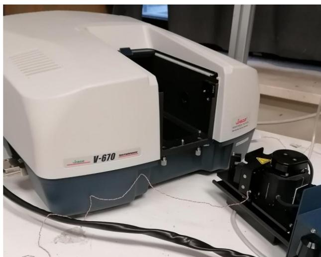
*Figura 3.4. Spettrofotometro Jasco V670.*
