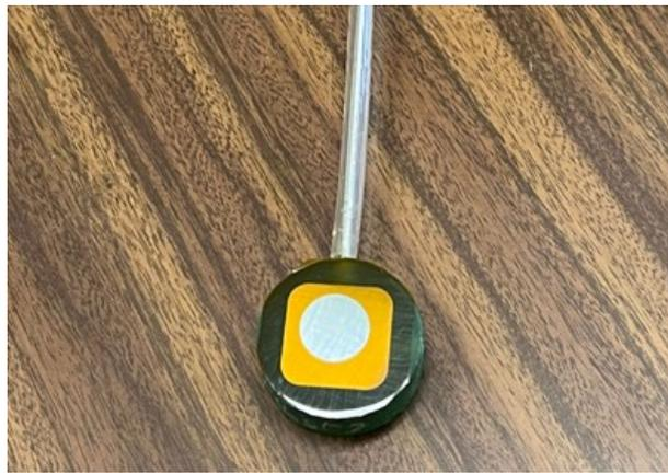
**Figura 3.5:** Campione con nastro in poliimmide e contatto elettrico.
