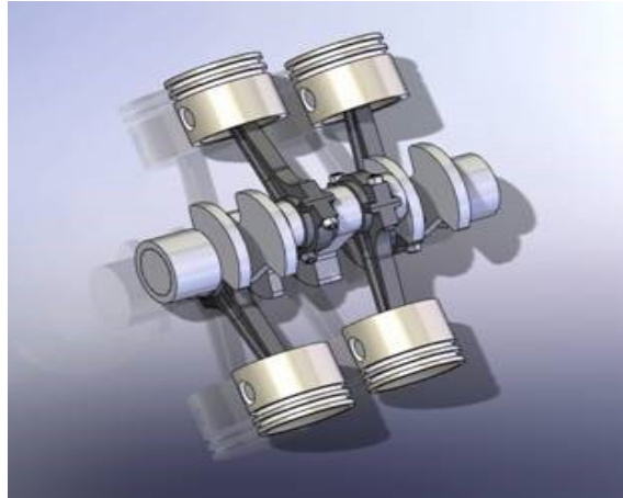
Figura 3: Manovellismo ordinario di un motore
