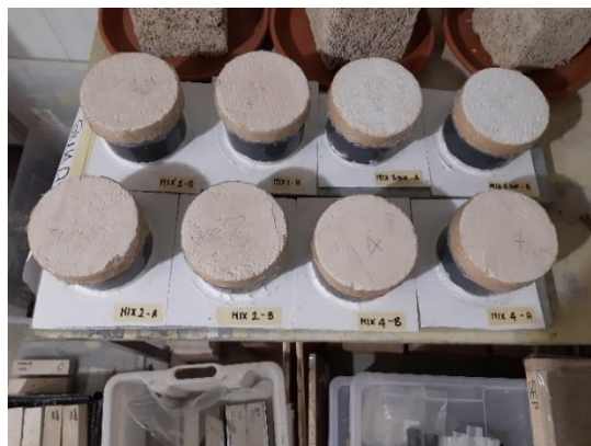
Figura 19: Sistema disco-supporto all'interno della camera climatizzata
