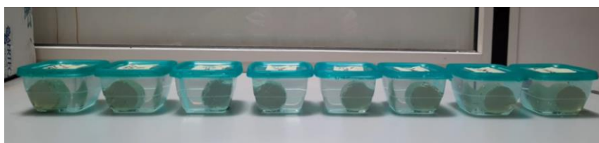
Figura 22: Provini immersi in acqua distillata in contenitori
