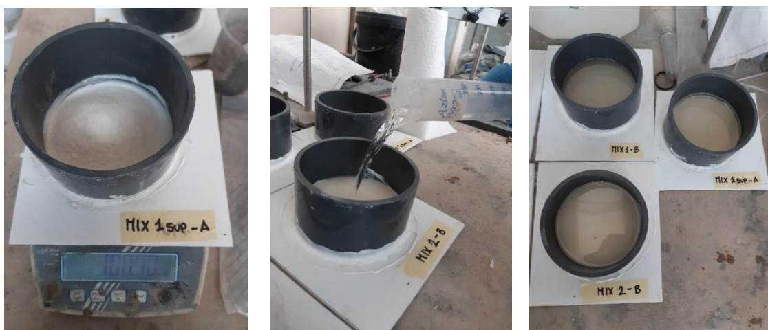
Figura 16: a sinistra 100 g di KNO_3 in polvere, al centro aggiunta di 200 g di acqua, a destra soluzione di KNO_3 in polvere e acqua miscelati
