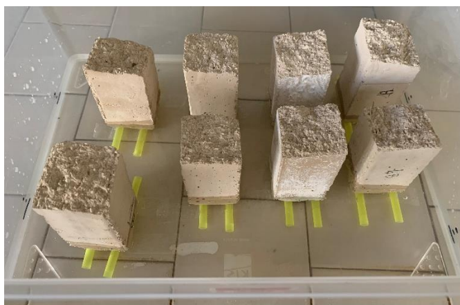
Figura 21: Provini posizionati sui supporti all'interno della bacinella con acqua distillata
