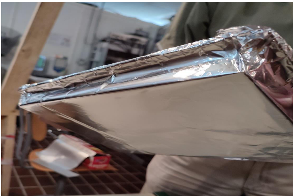
Figura 4.3.2 Campione pronto per la misura del fondo ricoperto da alluminio
