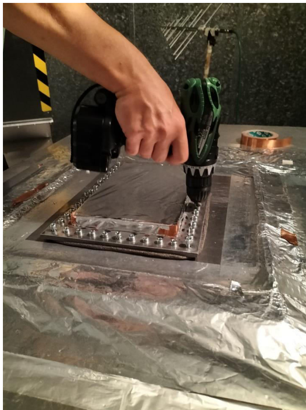
Figura 4.3.4 Serraggio delle viti per la preparazione della misura di fondo
