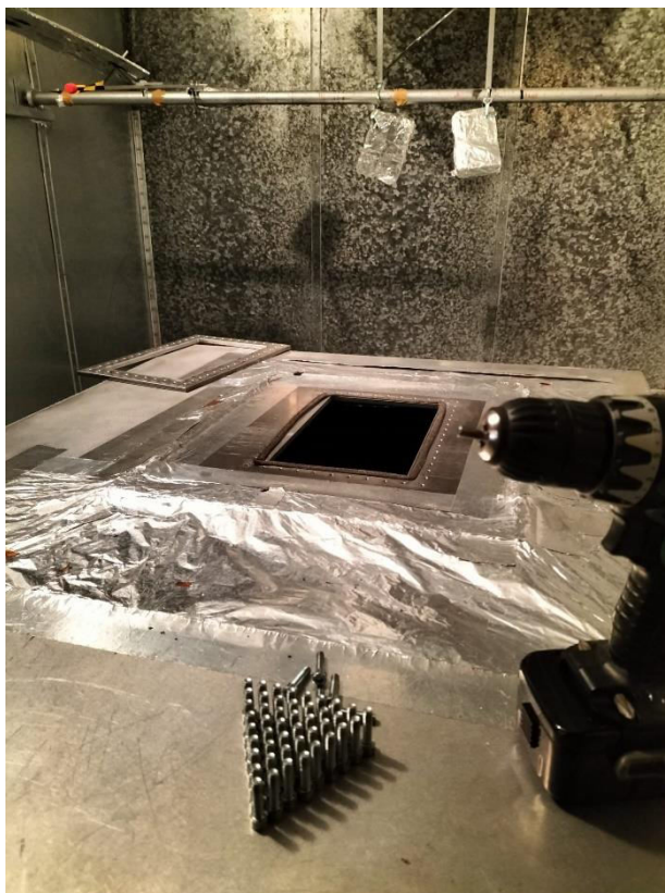
Figura 4.2.1 Campione e ghiera smontati che rivelano l'apertura della camera
