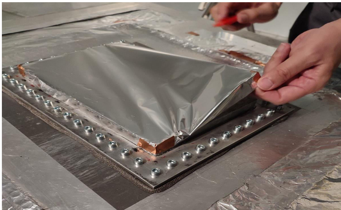
Figura 4.3.6 Rimozione del foglio di alluminio (con pezzi di nastro adesivo di rame)
