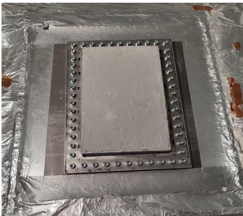
Figura 4.2.2 Campione fissato con i bulloni sulla ghiera
