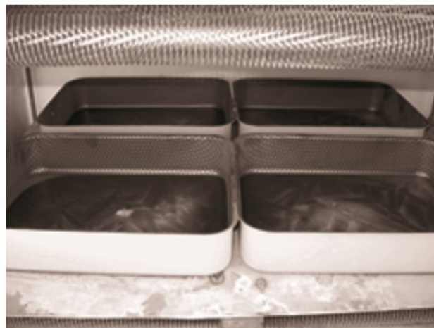
Figura 8 Ghiaccio prodotto all'interno del serbatoio [5]
