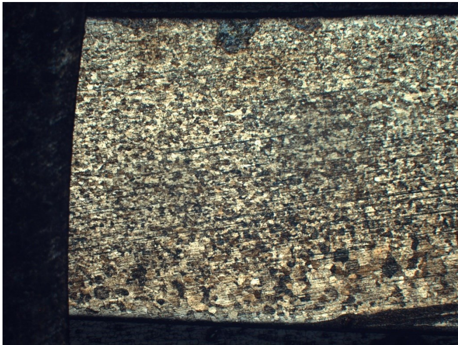
Figura 70. Micrografia 2,5\times 0,8 del provino ad una estremità del tratto utile
