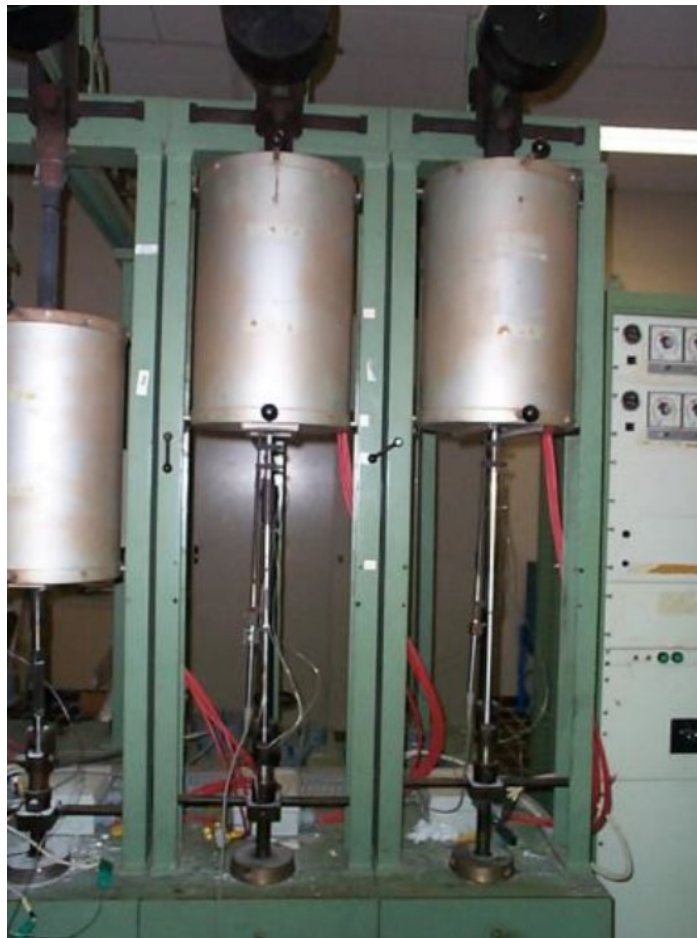
Figura 16. Macchina di creep dei laboratori UNIVPM
