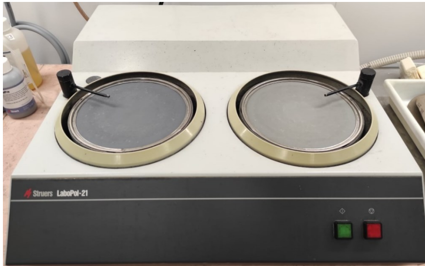
Figura 44. Lappatrice Struers LaboPol-21, utilizzata per la lappatura dei provini tramite dischi abrasivi e getto d'acqua
