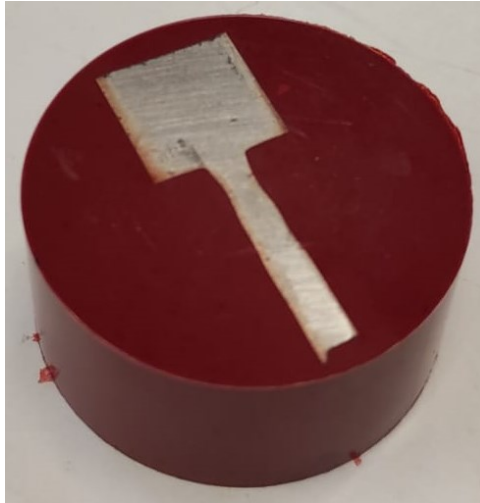
Figura 48. Provino inglobato a caldo con resina fenolica rossa
