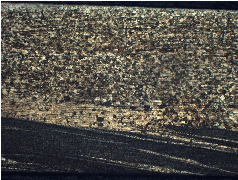
Figura 72. Micrografia 2,5×0,8 della zona centrale del tratto utile, ovvero la zona di saldatura
