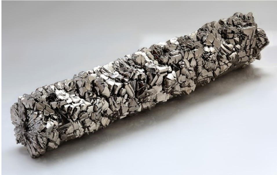
Figura 7. Barra di titanio puro ottenuta tramite il processo van Arkel-de Boer
