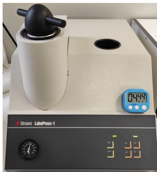
Figura 47. Macchina di inglobatura Struers LaboPress-1
