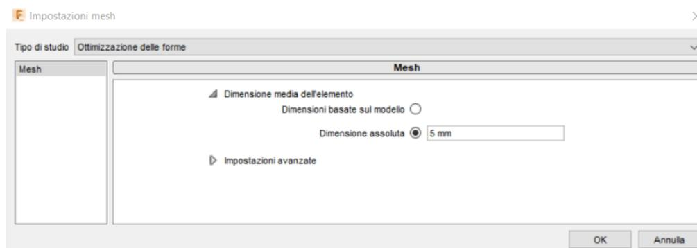
Figura 5.11: Dimensione della mesh applicata all'ottimizzazione della staffa.
