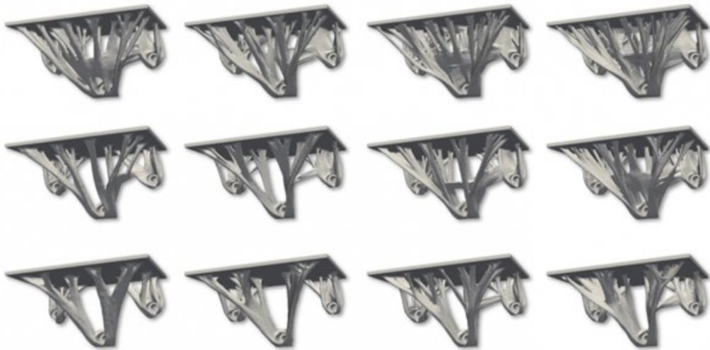
*Figura 4.2: Soluzioni ottenute mediante il Generative Design di un supporto meccanico.*
