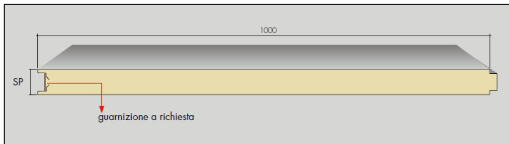
Figura 4.2: Vista della tipologia di pannello di rivestimento esterno adottato per il progetto oggetto di studio; Immagine tratta da: scheda tecnica Isopar – pannello isolante per parete.
