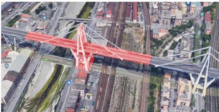
Figura 1.7 – Sezione crollata del Ponte Morandi<sup>2</sup>
