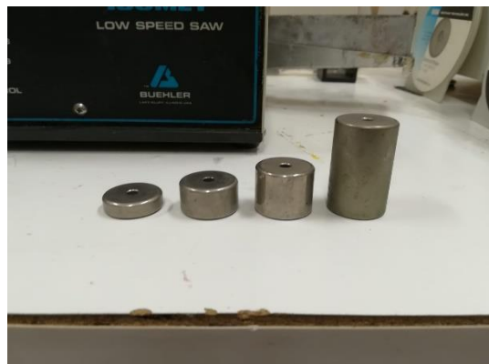
Figura 4.6: (a sinistra) Supporto in teflon; (a destra) Pesì per il taglio
