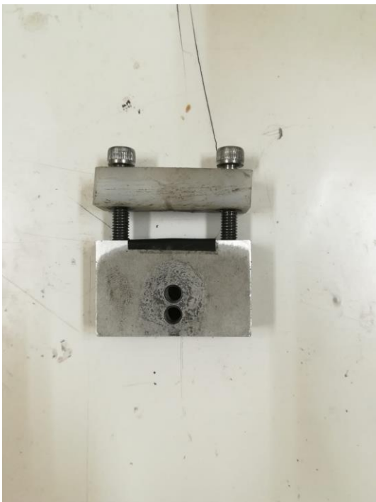
Figura 4.6: (a sinistra) Supporto in teflon; (a destra) Pesì per il taglio
