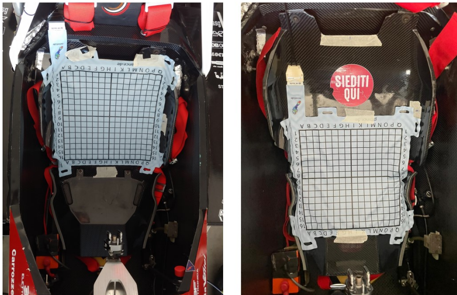
Figura 4.3: Misura pressione - Baseline - Caso statico
