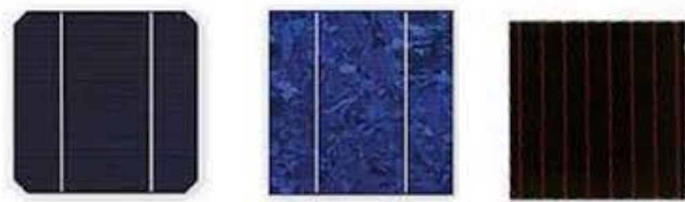
Figura 1-1: Tipologie di celle fotovoltaiche. Da sinistra: monocristallina, policristallina e amorfa.
