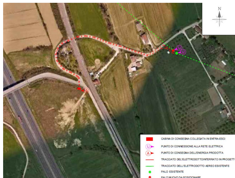
Figura 3-5: Estratto vista planimetrica su ortofoto progetto elettrico connessione
