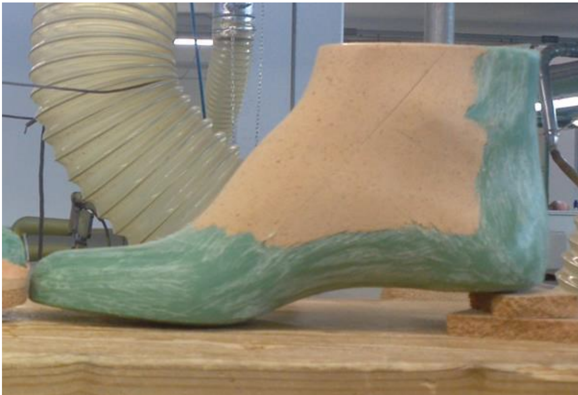
Fig. 8 - Forma realizzata in polietilene e modificata con sughero sintetico
