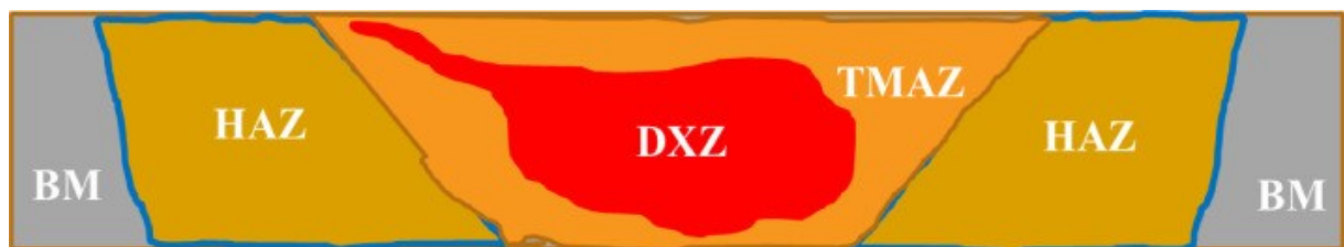
Figura 3.2 – Le diverse zone relative alla microstruttura
