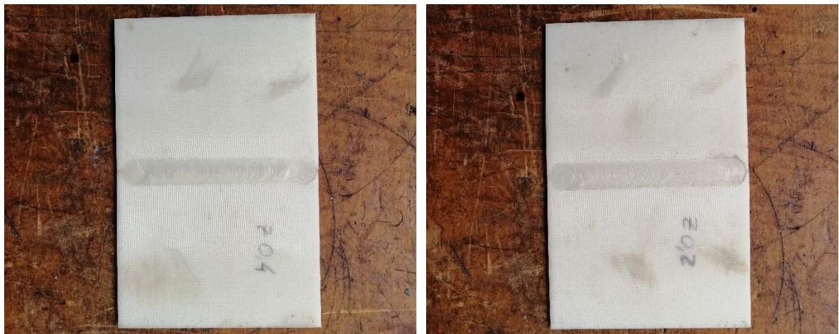
Figura 4.3 – Piastre saldate double side, con affondamento di 0,4 mm da un lato e 0,2 mm dal lato “di chiusura”
