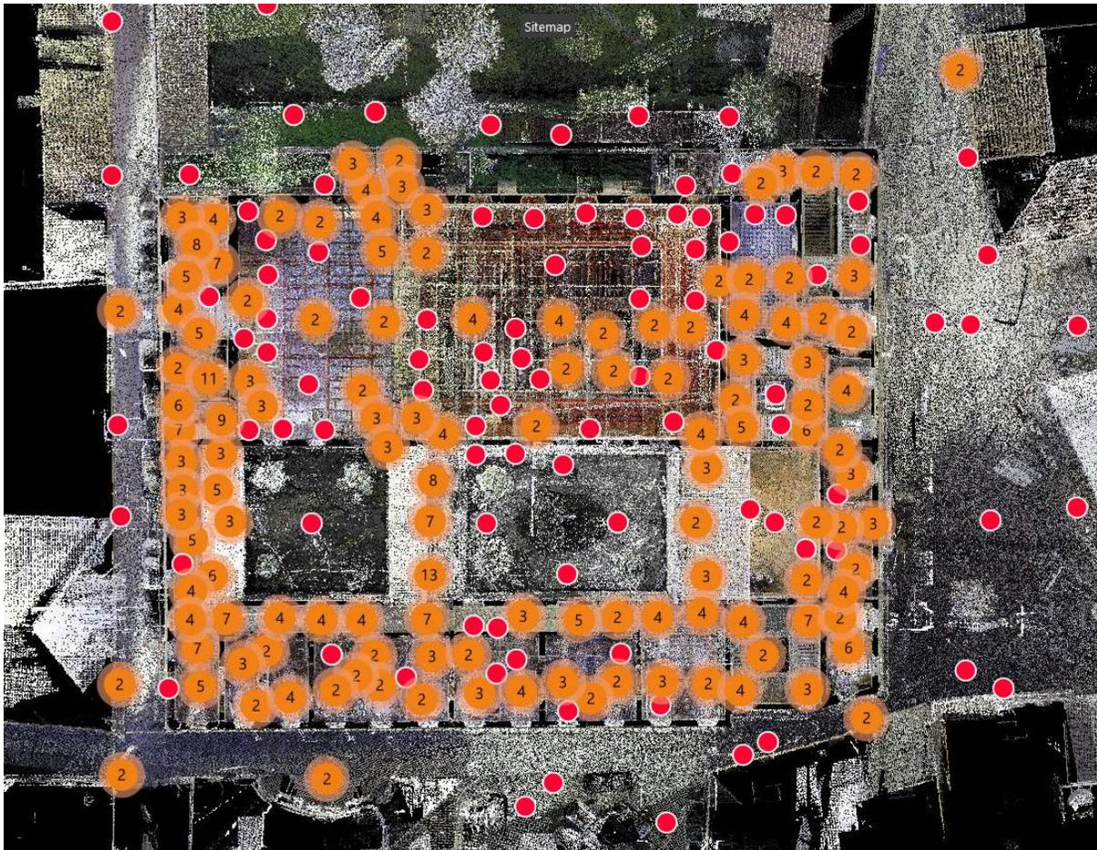
Figura 34. Vista planimetria con indicazione delle stazioni di scansione, in arancione i gruppi di scansione.
