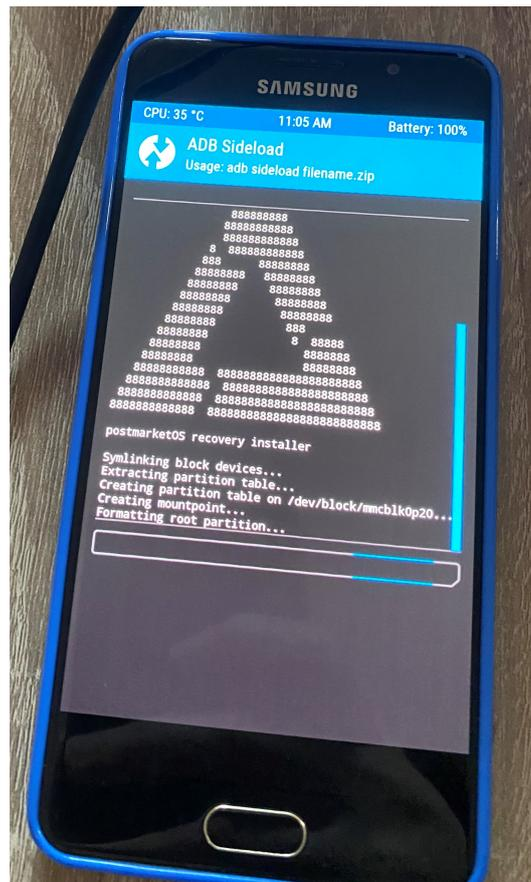
Figura 3.8: Installazione tramite “ADB Sideload” di PostmarketOS sul dispositivo Samsung a5xelte
