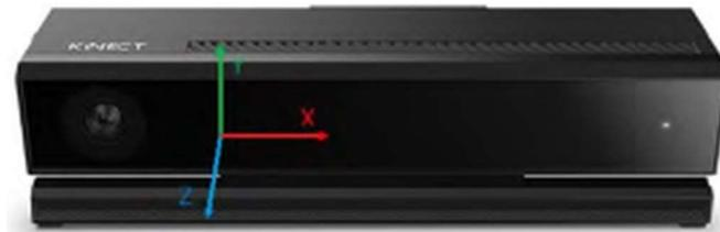
FIG. 39 Camera spaziale Kinect<sup>15</sup>
