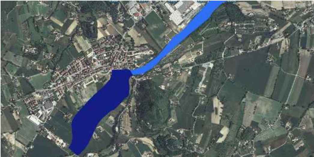
Fig. 104- l'immagine mostra il rischio di alluvione, che interessa il fiume Potenza in corrispondenza del centro abitato
