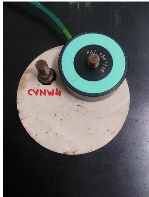
Figura 45 inserimento del corpo del pistoncino sul pull-stub
