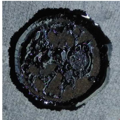
Figura 37 rottura adesiva/coesiva (a sinistra il pistoncino a destra l'aggregato)
