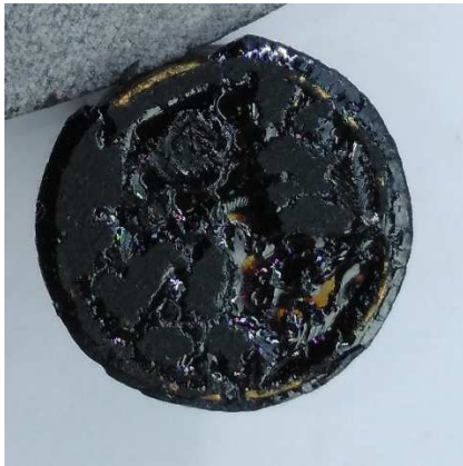
Figura 37 rottura adesiva/coesiva (a sinistra il pistoncino a destra l'aggregato)
