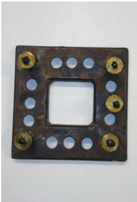
Figura 40 pistoncini prima dell'inserimento in forno a destra e dopo il riscaldamento in forno per trenta minuti a sinistra.
