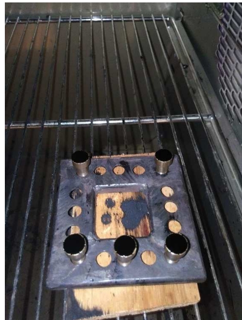
Figura 40 pistoncini prima dell'inserimento in forno a destra e dopo il riscaldamento in forno per trenta minuti a sinistra.
