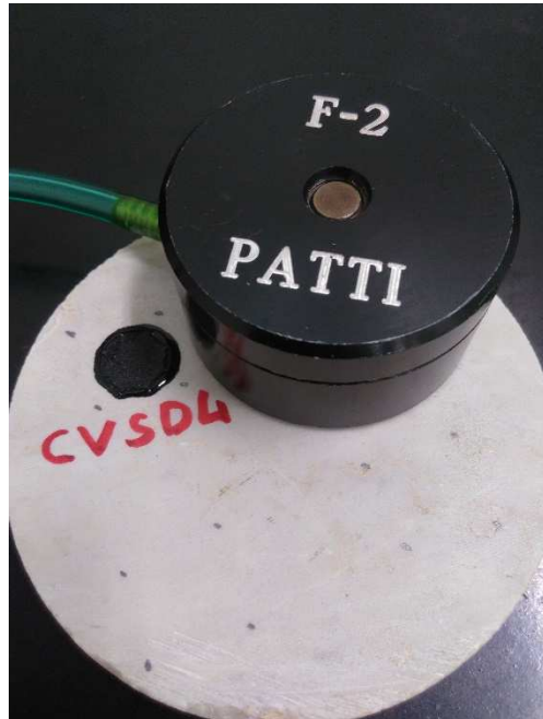
Figura 46 posizionamento del piatto di reazione sul pull-stub
