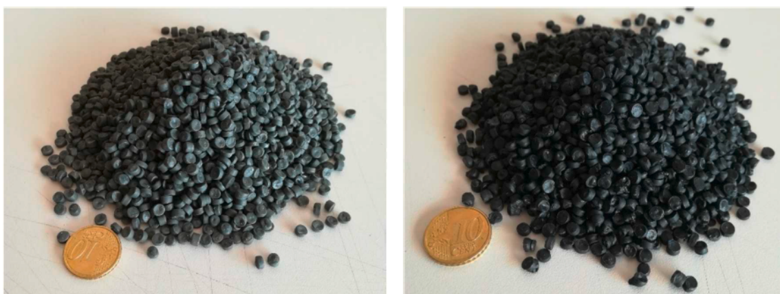
Figura 15 compound superplast a destra ed al grafene a sinistra
