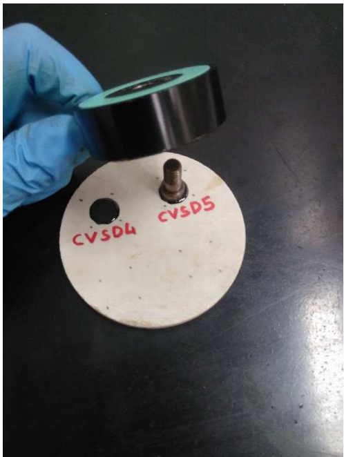
Figura 45 inserimento del corpo del pistoncino sul pull-stub
