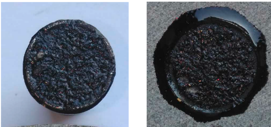
Figura 35 rottura coesiva (a sinistra il pistoncino a destra l'aggregato)
