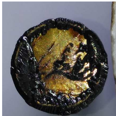
Figura 38 distacco del bitume (a sinistra il pistoncino a destra l'aggregato)
