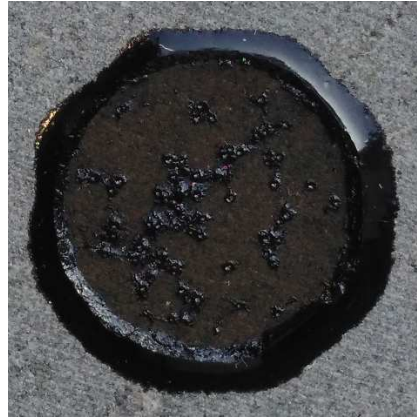
Figura 36 rottura adesiva (a sinistra il pistoncino a destra l'aggregato)
