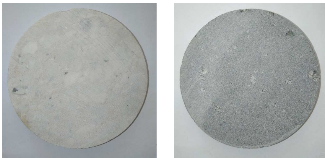
Figura 22 dischetti di calcare a destra e di basalto a sinistra
