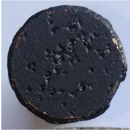
Figura 36 rottura adesiva (a sinistra il pistoncino a destra l'aggregato)
