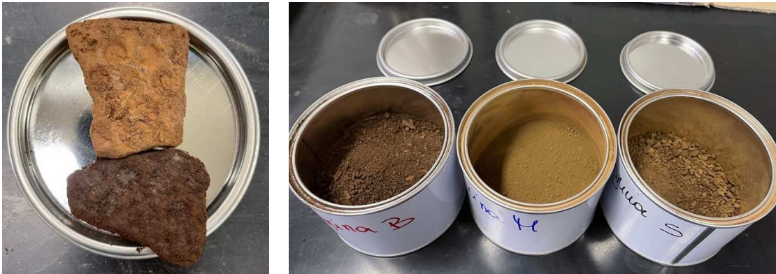
Figura 19 lignine prima dell'essiccamento in forno a sinistra e dopo la macinatura a destra
