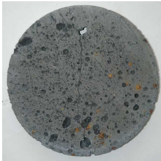
Figura 24 dischetto di scoria diametro 10 cm
