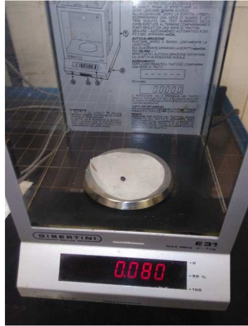
Figura 39 filamenti di bitume a destra e palline di bitume pesate a sinistra
