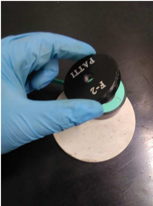
Figura 46 posizionamento del piatto di reazione sul pull-stub
