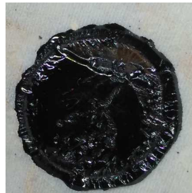
Figura 38 distacco del bitume (a sinistra il pistoncino a destra l'aggregato)
