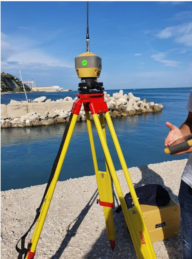
Figura 37 - Foto del ricevitore GNSS usato
