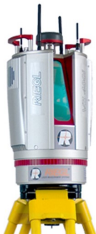
Figura 16 – Esempio di Laser scanner a Tempo di Volo – Riegl VZ-400i
