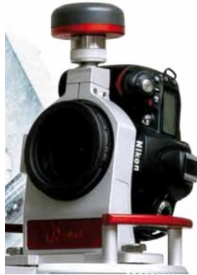
Figura 30 - Fotocamera posta sopra al laser scanner
