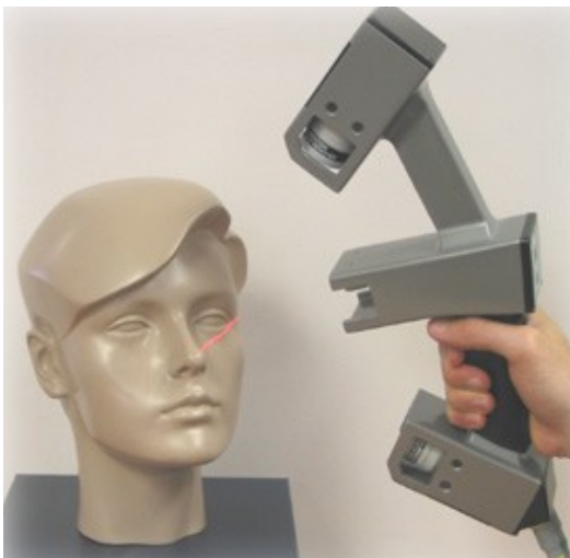
Figura 12 - Esempio di applicazione laser scanner a triangolazione
