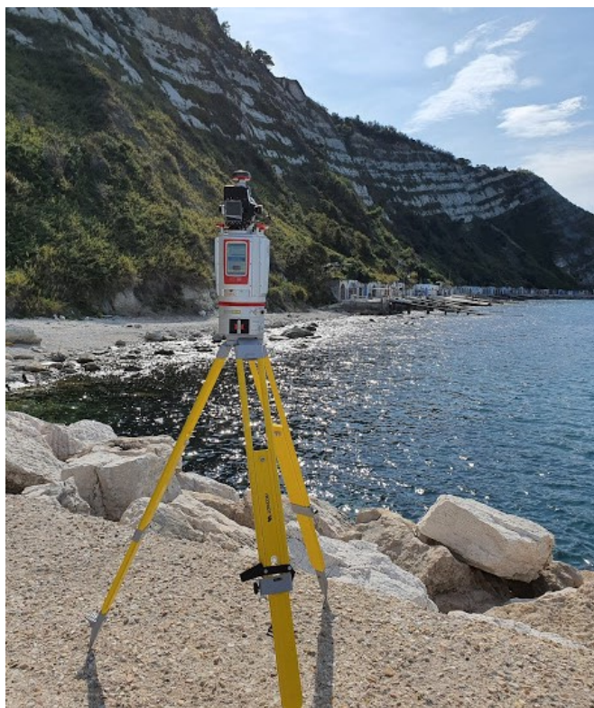
Figura 31 - Foto del laser scanner in fase di rilievo
