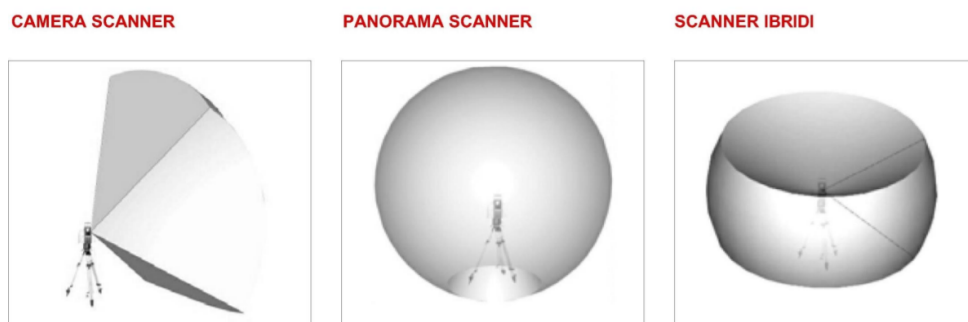
Figura 24 - Campi visivi nelle diverse tipologie di laser scanner
